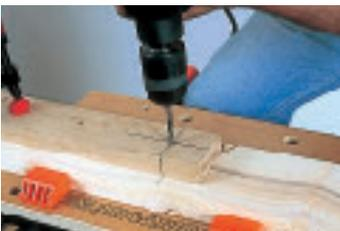
9. Lorsqu'il est nécessaire de percer verticalement, s'aider d'une équerre posée à côté du perçage.
