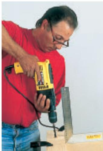
8. Un morceau de bois dur, percé avec soin, sert de guide de perçage pour effectuer en série des trous bien verticaux.
