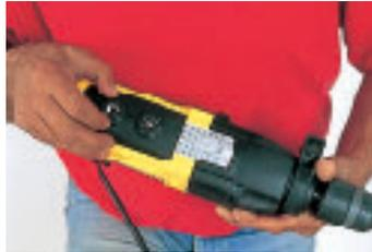
3. Régler la vitesse en fonction du tableau imprimé sur la perceuse ou dans sa notice.
