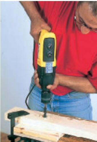
4. Pour percer le bois sans éclats avec une mèche hélicoïdale : placer un "martyr" (un morceau de bois) sous la pièce à percer et continuer le perçage dans ce martyr.
