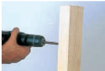
5. Pour ne pas faire éclater le bois avec une mèche plate, percer en deux fois : d'un côté jusqu'à ce que la pointe de centrage ressorte à l'opposé...
